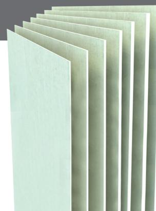
Es una placa plana de fibrocemento fabricada con la más avanzada tecnología, a base de cemento, sílice, fibras de celulosa y aditivos; fraguada en autoclave. Durante este proceso las placas son sometidas a alta presión y temperatura, obteniéndose un producto resistente a la humedad, de gran durabilidad y resistencia mecánica. Siendo versátiles, trabajables, resistentes y durables como el cemento.
