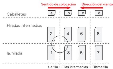
Las Tejas Españolas tienen un solo sentido de colocación (de izquierda a derecha). Su colocación debe iniciarse de abajo hacia arriba en el orden indicado.
