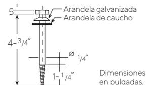
Los elementos de fijación en los caballetes siempre deben ser instalados en las crestas de las ondas, nunca en los lomos.
