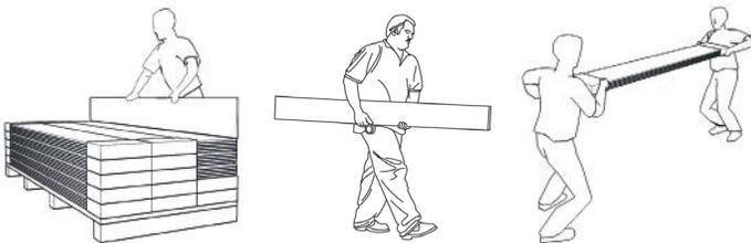
Cada paquete o pieza de Plydeck debe ser cargado en forma horizontal por dos personas. Proteja los bordes y esquinas para evitar que se rompan. Transporte las láminas de Plydeck de Plycem por el centro de su borde angosto.
