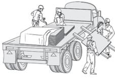
La Fachada Tek debe ser transportada en una plataforma firme y plana, con protección contra la humedad.
