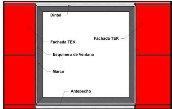
**Nota:** Tanto los perfiles de botaguas como los esquineros y perfiles de ventana deben colocarse previamente a la colocación de la barrera de humedad.
