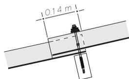
Para instalar los tornillos auto perforantes es necesario utilizar, "Atornillador con torque graduable", NUNCA utilice taladros.
