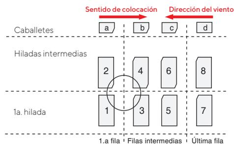
Las tejas Sevillanas tienen un solo sentido de colocación (de izquierda a derecha). Su colocación debe iniciarse de abajo hacia arriba, en el orden indicado. Para la colocación del caballete en este tipo de cubiertas, debe tenerse en cuenta que las ondulaciones de las tejas en la cumbre coincidan de un lado y otro, lo anterior para garantizar que los caballetes traslapen correctamente.
