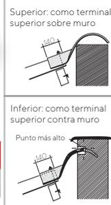
El caballete superior siempre debe instalarse en el faldón de la fachada. Esta pieza se debe cortar en obra en su parte superior (curvatura del caballete) por el punto más alto, de acuerdo con la inclinación de la cubierta, como se indica en el esquema.
