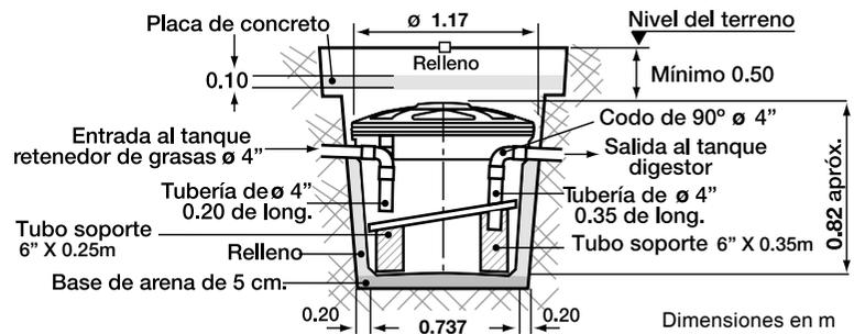
**2. Tanque digestor (séptico) de 1000 l.**
