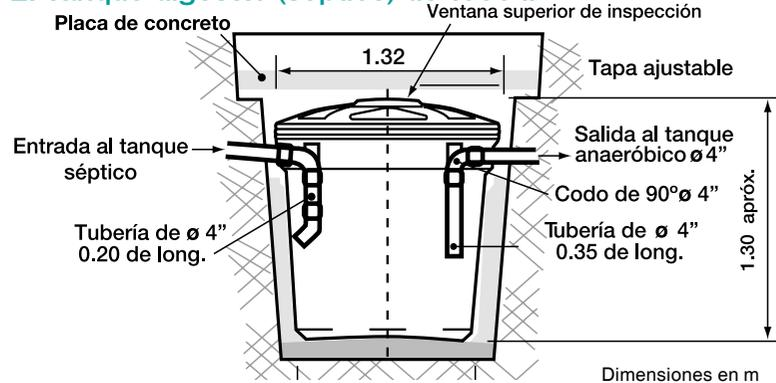
**3. Tanque filtro anaeróbico de 1000 l.**
